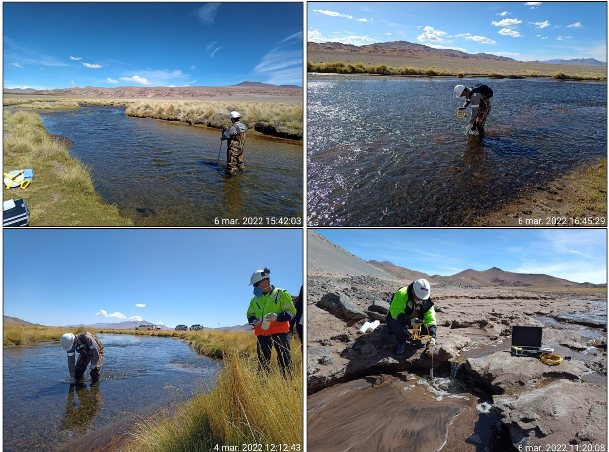
Foto II-12. Monitoreo, medición de parámetros y recolección de muestras en sitio SV-M2 (arriba a la izq.), SV-M3 (arriba a la der.), SV-M4 (abajo a la izq.) y SV-M8 (abajo a la izquierda)
